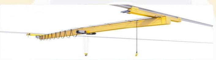
Realizamos projetos e memoriais de calculo para qualquer tipo de ponte suspensa univiga e dupla viga. Sendo analisado os seguintes itens:
